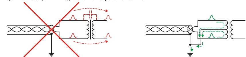
2. Применение газонаполненного разрядника в схеме подключения к заземлению обеспечивает отсутствие уравнивающих токов в кабельных системах, неохваченных системой уравнивания потенциалов. Это позволяет заземлить оба конца защищаемого кабельного сегмента. Это же решение обеспечивает высокую импульсную стойкость устройства, т.к. в схеме отсутствуют какие-либо ограничивающие допустимую мощность элементы.
