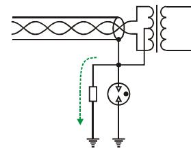
5. Быстро действующие импульсные диоды совместно с TVS-диодом обеспечивают эффективное подавление противофазной помехи до безопасного уровня. Низкая барьерная емкость импульсных диодов обеспечивает высокую степень согласования сигнального тракта даже на высоких частотах, при передаче данных на скорости 100 Мб/С.
