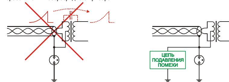
4. Шунтирующее газоразрядное прибора высокомоментным резистором обеспечивает "мягкое" стекание электростатических зарядов, оседающих на кабельном сегменте при выпадении осадков и индуцируемых грозовыми облаками. Это снижает нагрузку на газоразрядный прибор и уменьшает потери данных в условиях высокой напряженности электростатических полей.
