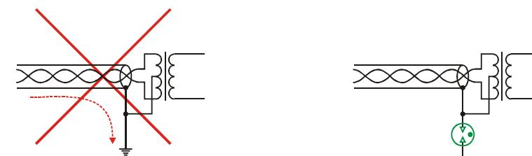
3. Цель подавления помехи обеспечивает нейтрализацию импульсной помехи, возникающей при срабатывании газоразрядного прибора.
